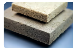
Diese Holzschäumplatte ist ein hundertprozentiges Naturprodukt aus nachwachsenden Rohstoffen. Foto: M. Lingnau/ Fraunhofer WKI
